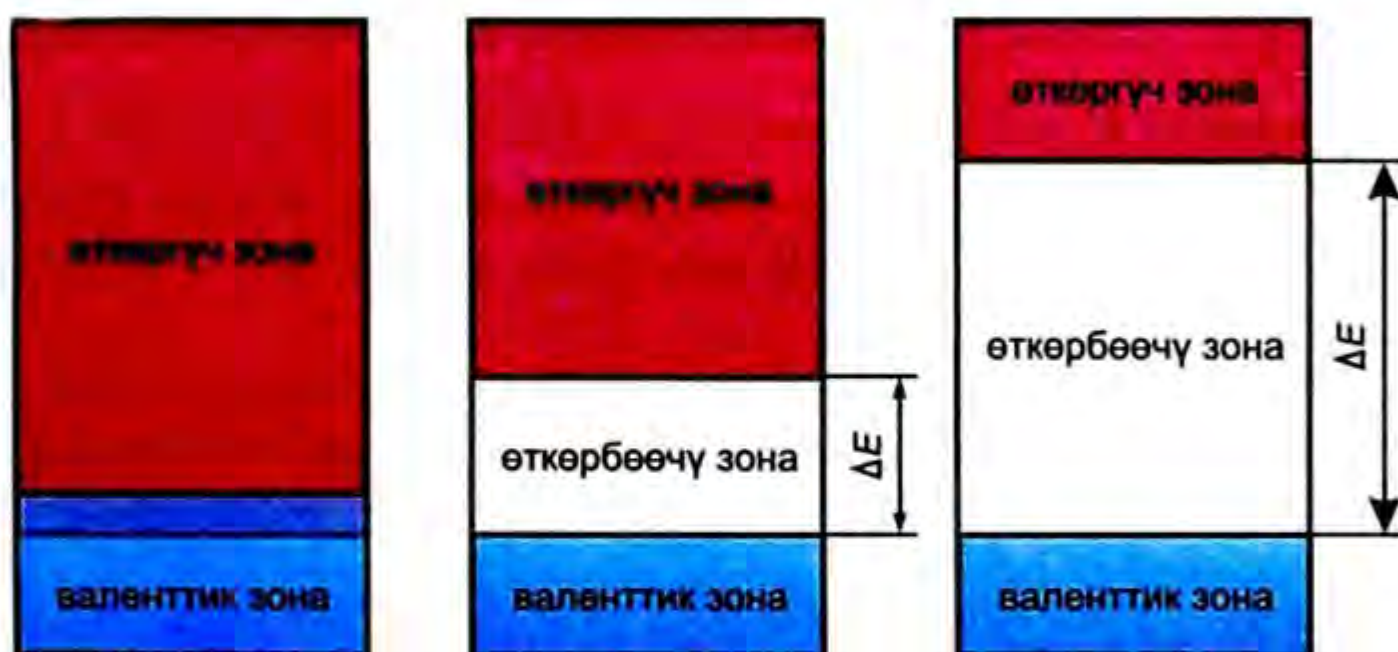
3.6-сүрөт. Өткөргүч (а), жарым өткөргүч (б) жана изоляторлордун (в) энергетикалык деңгээлдеринин зоналык структурасы.
