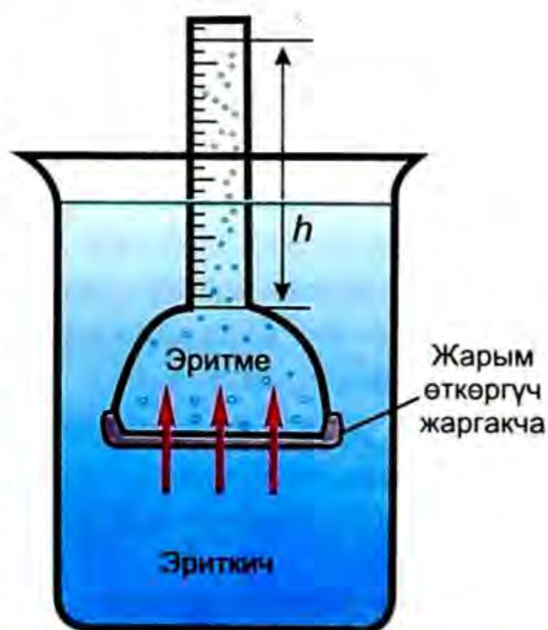
4.6-сүрөт. Осмометрдин иштөө принциби.
